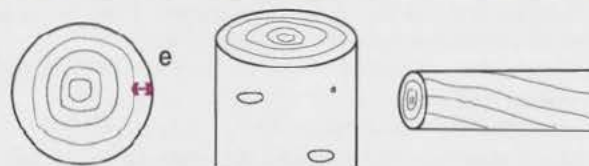
a largeur des cernes b diamètre des nœuds c pente du fil
